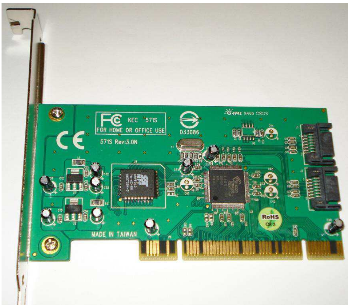
Na obrázku přídavná karta s dvěma SATA interními konektory určená do PCI slotu.
